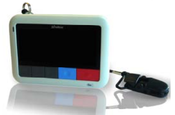
Notruf-Pager mit Display und allen Alarmfunktionen
