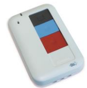
Notruf-Geber mit Druck- und Lagealarm
